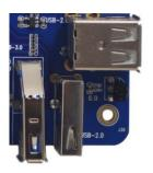
RK3399 自带有两路 USB HOST2.0 接口,两路 TYPEC 接口,其中一路 TYPEC,在 x3399 上用作了 USB3.0 接口,上图最左侧接口对应 USB3.0。USB3.0 右侧的竖插 USB 座为 RK3399 自带的一路 USB HOST2.0 接口,在右边还有一个双层 USB HOST 接口,它是 RK3399 自带的另一路 USB HOST2.0 经过一个 HUB 芯片转换而来。如此丰富的 HOST 接口,相信已经满足了绝大多数应用场景。
