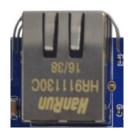
x3399 支持千兆有线以太网接口,板载 RTL8211E,用户可以通过有线以太网上网,体 验极速网络。
