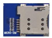
X3399 开发板的背面有一个 PCIE 座,它用于接 PCIE 接口的 3G、4G 通讯模块。当然 在使用 3G 和 4G 时,需要在这个 SIM 卡槽内插入对应的手机卡。
