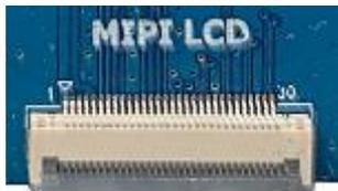
X1808 开发板默认留有一个 30PIN 的 DSI 接口，通过软排线将 MIPI 相关信号连接到 LCD 控制板上，进而控制 LCD。同时，这个 30PIN 接口的第 12 管脚为 PWM 脚，用于控制 LCD 的背光，通过 PWM 实现多级背光亮度调节。同时，它上面还引出了用于电容触摸的 I2C 以及中断，唤醒信号。
