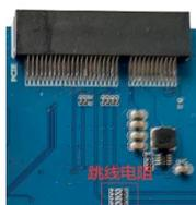
X1808 支持 PCIE 接口，接口下面标红处为 4 对跳线电阻，用于 PCIE 和 HOST3.0 的切换，默认为 HOST3.0 模式。如需使用 PCIE 接口，需将右边的四个电阻焊到左边。
