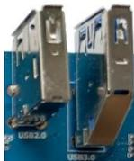
X1808 自带两路 USB HOST 接口，其中一路 HOST2.0，一路 HOST3.0。上图中左侧对应 USB HOST2.0 接口，右侧对应 USB HOST3.0 接口。注意，右侧的 USB3.0 接口兼容的 USB2.0 功能，和用于程序下载的 OTG 功能复用，该 USB3.0 接口如果需要使用 USB2.0 功能，需要通过一根 OTG 转 USB HOST 转换线将 OTG 切换到 HOST 模式，否则 USB3.0 口的 HOST2.0 功能失效。另外，该 USB3.0 接口的 HOST3.0 功能，和 PCIE 接口的部分管脚复用，通过跳电阻的方式切换，默认为 USB3.0 接口。
