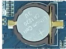
后备电池用于保证掉电后 RTC 仍能正常工作，确保系统时间不丢失。
